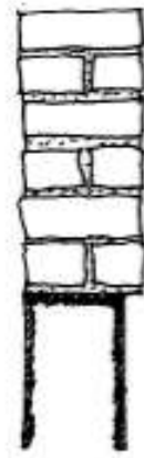
Figure 29: Exemple de débord du mur en terre par rapport au soubassement
